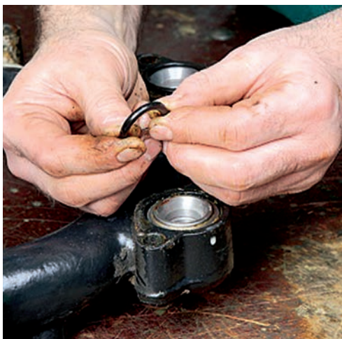
Рис. 169. Замена уплотнительных колец круглого сечения
