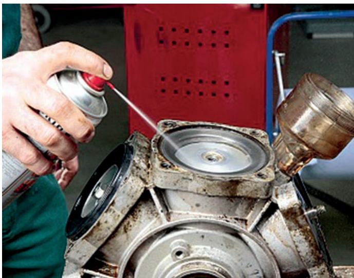
Рис. 163. Очистка места посадки мембран аэрозолем для очистки тормозов
