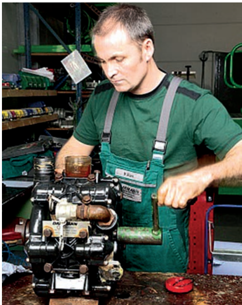
Рис. 172. Вращение насоса самостоятельно установленной рукояткой
