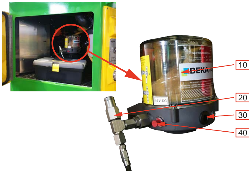
Рис. 48. Заполнение системы централизованной смазки
