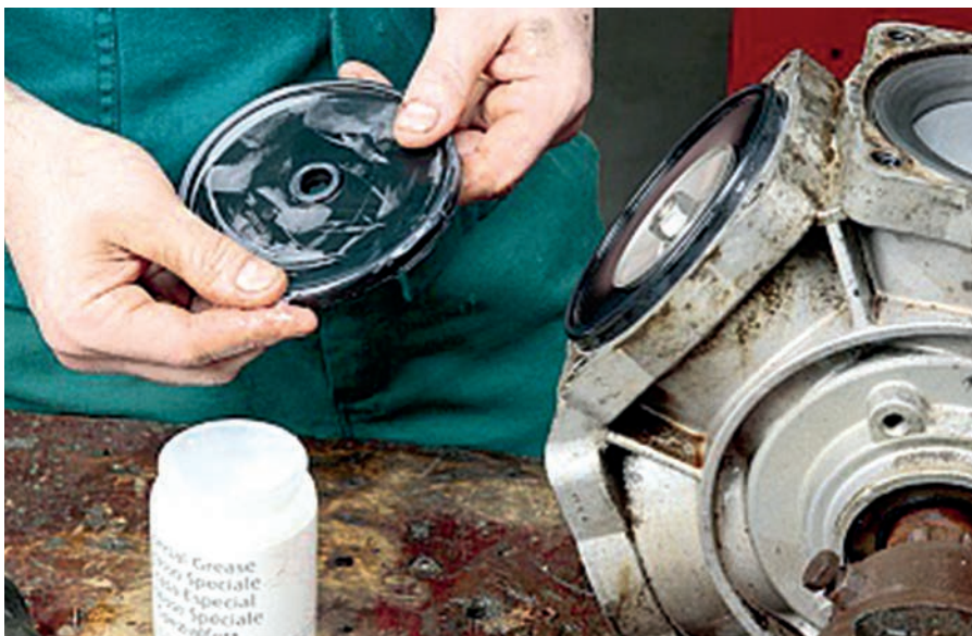
Рис. 170. Смазывание всех резиновых деталей консистентной смазкой перед сборкой
