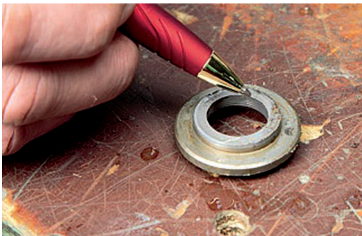
Рис. 168. Проверка металлических дисков клапанов на износ
