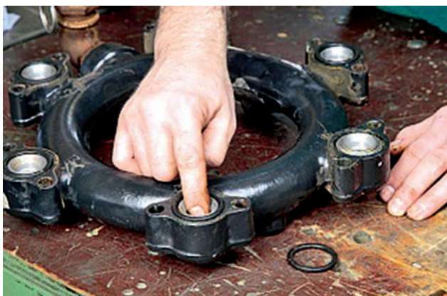
Рис. 167. Проверка пластин клапанов
