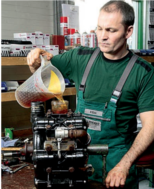
Рис. 171. Заливка моторного масла 10 или 15
