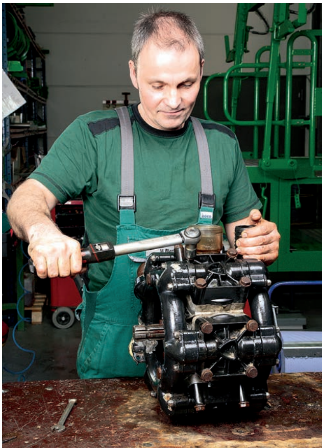
Рис. 154. Регулярная проверка насоса и замена изношенных быстроизнашивающихся деталей.
