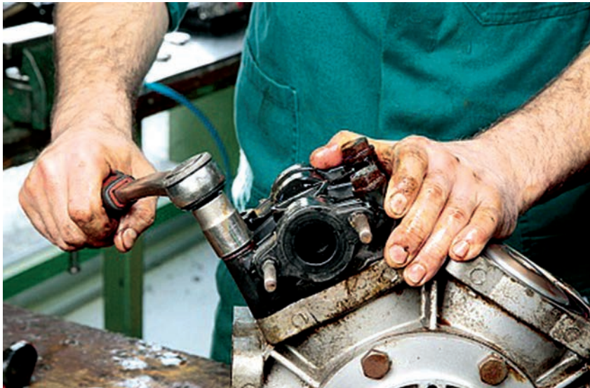
Рис. 157. Демонтаж цилиндрической головки
