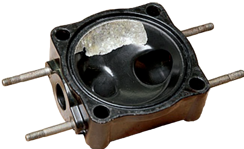
Рис. 158. Поврежденное пластмассовое покрытие
