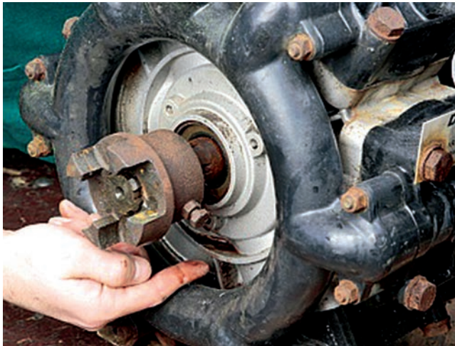
Рис. 159. Потери масла на коленчатом валу
