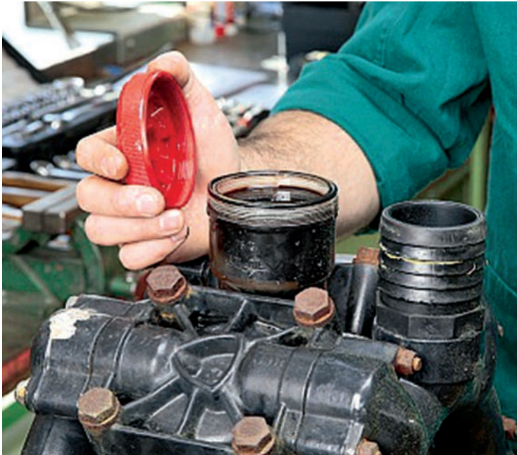
Рис. 155. Точно соблюдайте минимальную и максимальную отметки на запасном масляном резервуаре.
