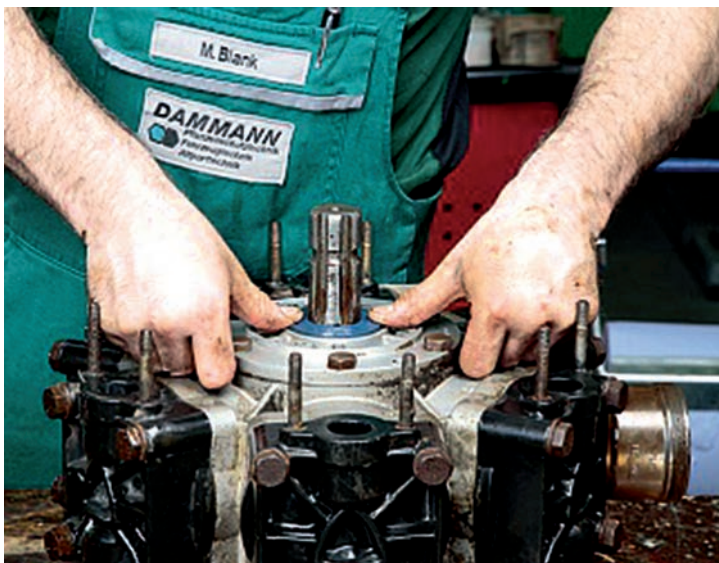
Рис. 161. Демонтаж уплотнения вала
