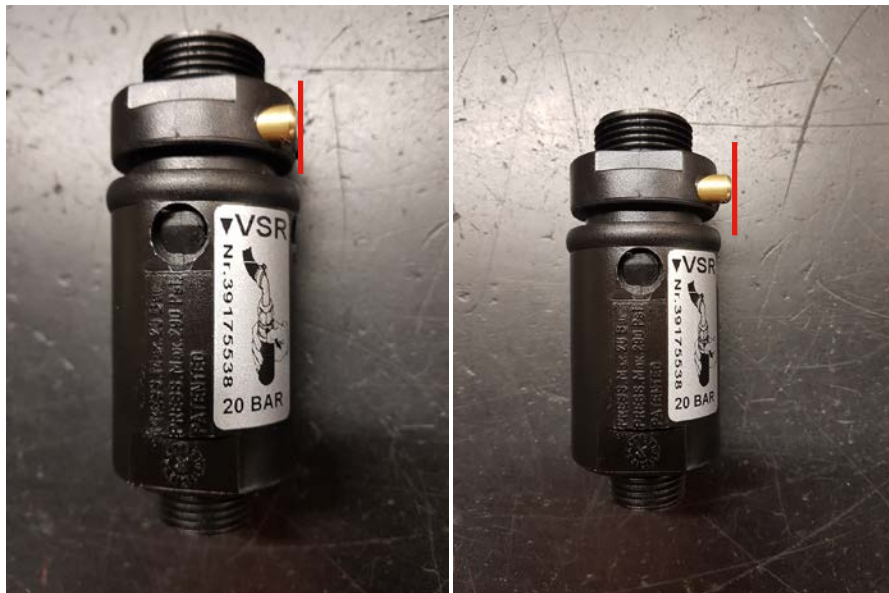
Рис. 173. Предохранительный клапан: несработавший (слева), сработавший (справа)
